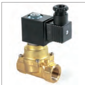
ELETTROVALVOLA SERIE 84 2/2 NC A MEMBRANA SERVOASSISTITA CON BOBINA 24VDC
